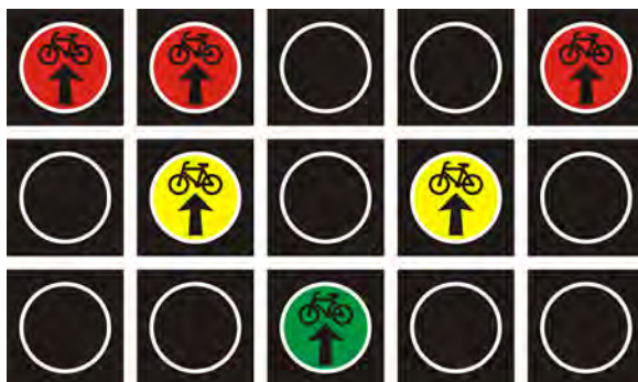
Rys. 4.2.3. Sygnalizatory kierunkowe S-3 i S-3a z sygnałami kierunkowymi w lewo:
