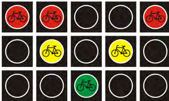
Rys. 4.2.2. Sygnalizatory kierunkowe S-3 i S-3a z sygnałami kierunkowymi na wprost:
