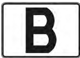
Rys. 3.2.14.2a. Tabliczka T-31 wskazująca kategorię tunelu
