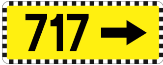
Rys. 6.3.7.12 Znak E-15e ze strzałką kierunkową skierowaną w prawo
