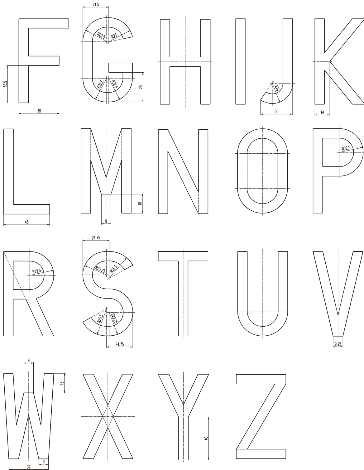
Rysunek 7. Wzory zwężonych liter do tablic samochodowych
